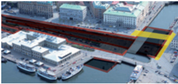
Haga - Korsvägen och Haga Chalmers via Packhusplatsen. Schakt och etableringsområde vid Lilla torget. Nya länkar för trafiken och en akvedukt för båttrafiken.
