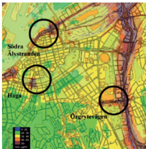
Dygnsmedelvärde \text{NO}_2 ( \mu\text{g}/\text{m}^3 ), Haga – Korsvägen via Södra Älvstranden 2010. Mörkröd färg innebär risk för överskridande av MKN, svarta cirklar visar platser där MKN riskerar att överskridas p g a byggnation av Västlänken.
