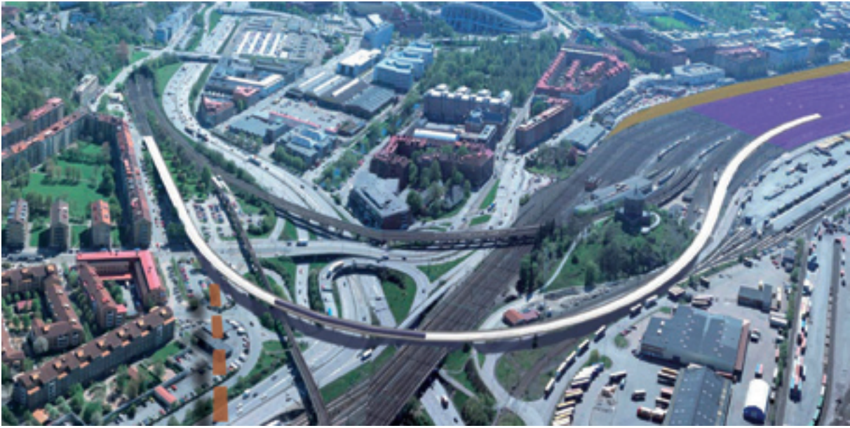
Ny bro över Västra Stambanan, E6 och Redbergsvägen i Förstärkningsalternativet. Även godstågsviadukten byggs om.
