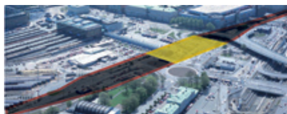
Flygbilden till höger visar schakt- och etableringsområde norr om Göteborg Central. Det gula området visar vilket område som kan komma att användas för överbyggningar under de olika byggetapperna.
