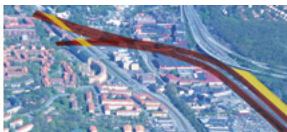
Tunneln övergår från berg till lera söder om Liseberg. Här uppstår konflikter med trafiken på Mölndalsvägen och på Sofierogatan. Även verksamheten vid SAAB:s växellådsfabrik påverkas.
