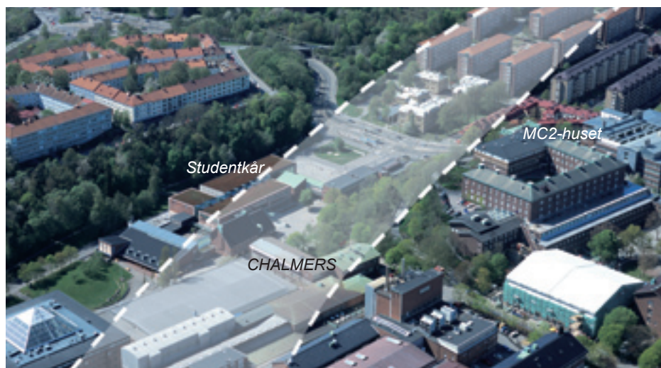
Bilden visar alternativ Haga-Chalmers, sträckning under Chalmers inkl. arbetsområde. Spåren ligger i bergtunnel på 45-60 meters djup under området
