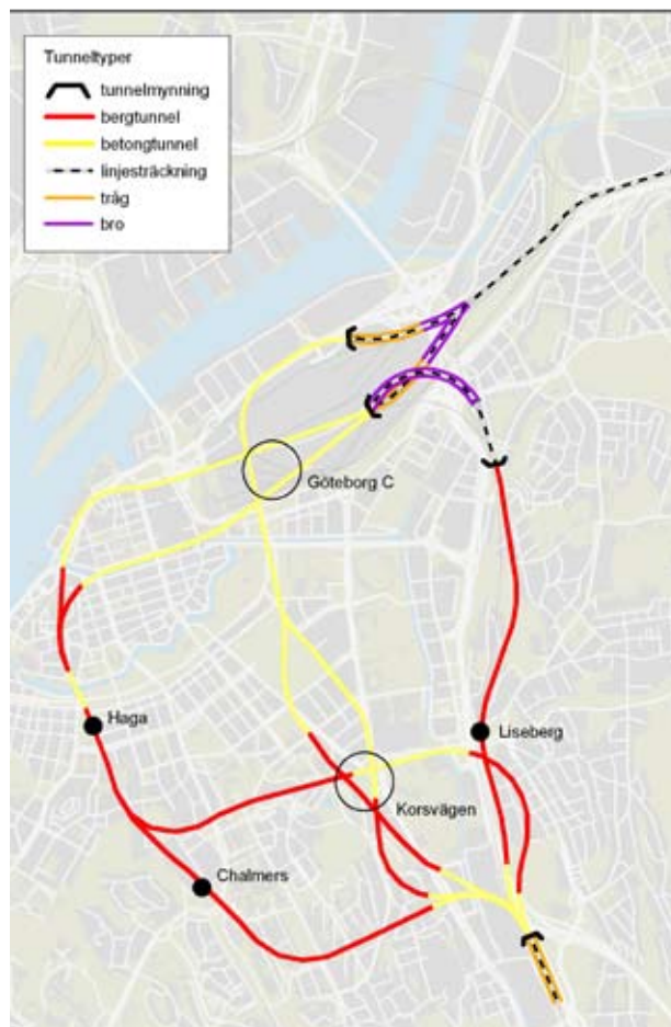
Rödmarkerad sträcka är sprängd tunnel i berg. Längs övriga sträckor och vid övergång mellan tunnel i berg och betongtunnel i jord finns risk för att kulturmiljön påverkas.
