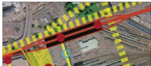
Illustration av fyrspårsstation med två perronger vid Gbg C.
