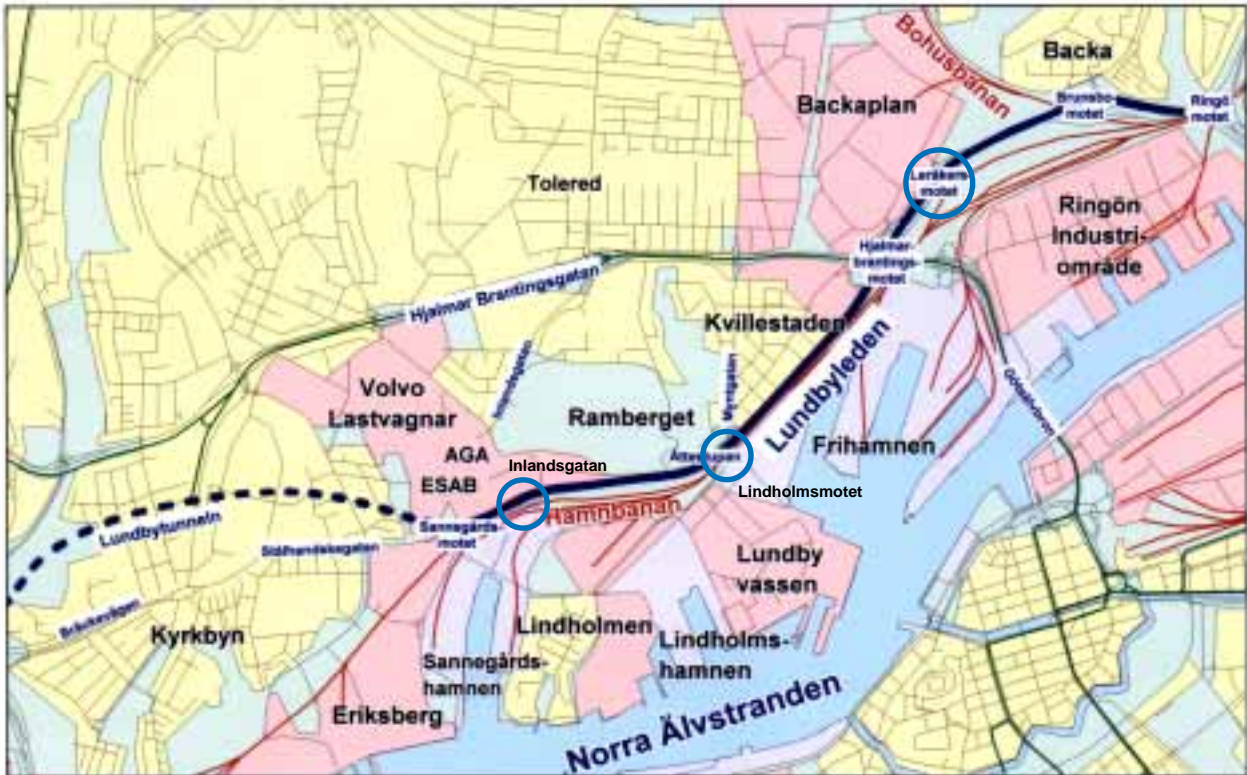
Lundbyleden kapacitetsförstärks och byggs ut med planskilda korsningar. Källa: Gatubolaget
