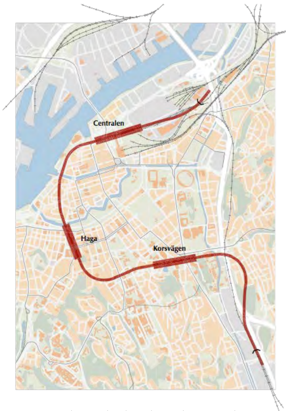
Figur 1. Tre stationer planeras utmed tunneln: Centralen, Haga och Korsvägen. Dessa hanteras i varsin detaljplan. Själva linjesträckningen (spårtunnelområdet) utgör en fjärde detaljplan (Trafikverket 2013). Karta: Göteborgs Stadsbyggnadskontor.
