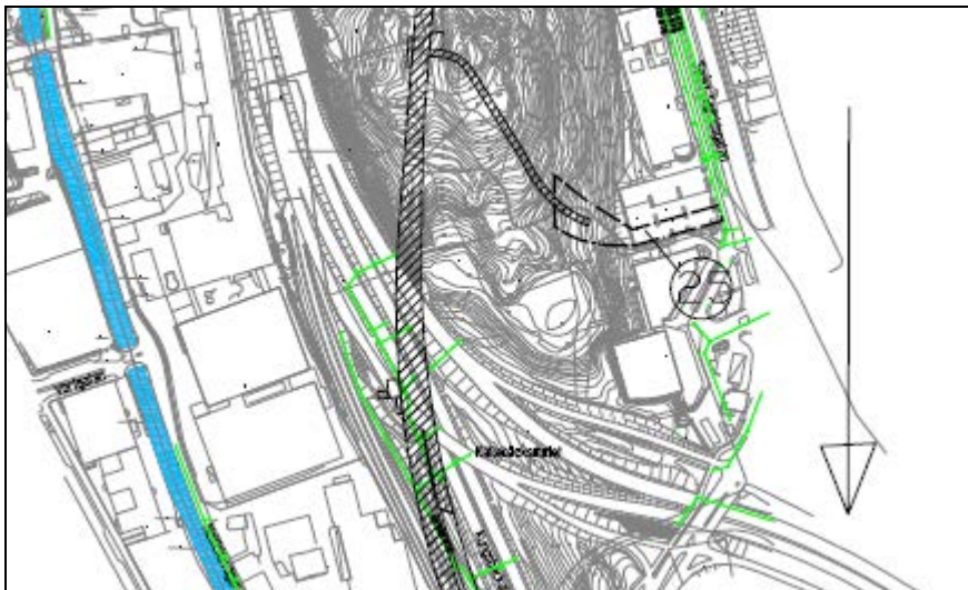
Figur 16. Avrinningsområde från planerad räddningstunneln vid St. Sigfridsgatan
