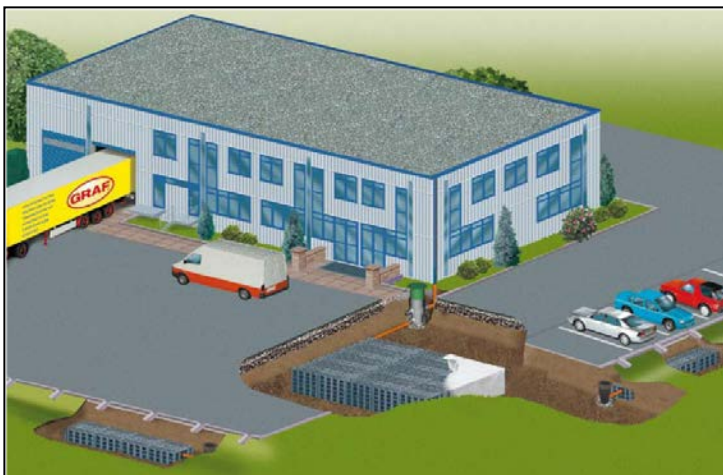
Figur 25. Exempel på utjämningsmagasin bestående av dagvattenkassetter (Uponor)
