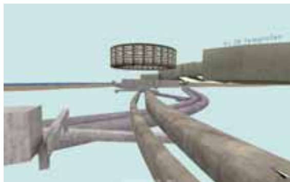
3D-modellen visar hur Västlänken med service-/räddningstunnel till vänster passerar över Götatunneln i Otterhällan sett mot norr från Rosenlund (mark- och bergytan är borttagna i bilden).
