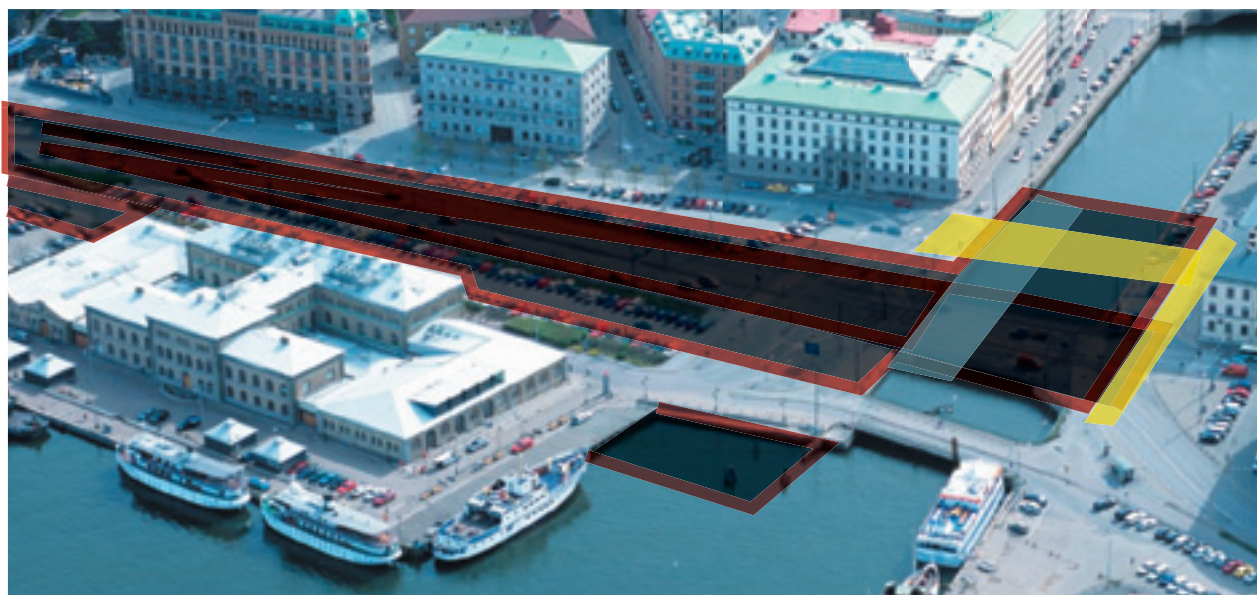
Figur 10. Schakt och etableringsområde vid Lilla torget. De gula fälten visar nya länkar för trafiken och det blåa en akvedukt för båttrafiken i kanalen.
