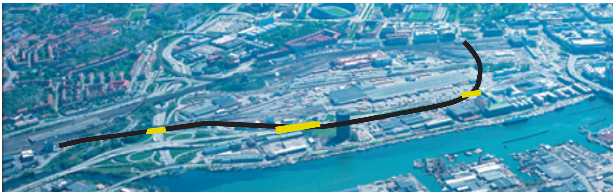
Figur 37. UA Korsvägen har den nordligaste tunneldragningen genom Gullbergsvass. Vilket innebär att konflikter med tågtrafikering koncentreras till GBG-C som får allvarliga konsekvenser då stationen ligger tvärs bangården. Korsningen med Mårten Krakowleden innebär konflikter med biltrafiken som kan klara genom omflyttningar och överbyggningar.
