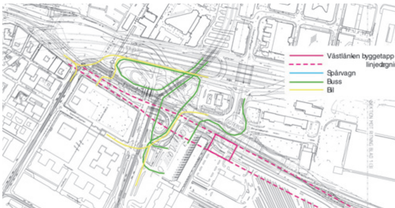
Figur 9. Exempel på hur trafiken vid Göta älvbrons södra avfarter kan ledas om under en byggetapp
