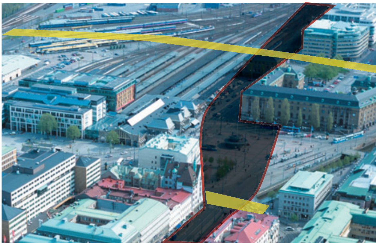
Figur 20 (ovan). Byggområdets utsträckning vid Drottningtorget. De gula fälten visar Bangårdsviadukten och en nödvändig överbrygning vid mötet med Stora Hamnkanalen.
