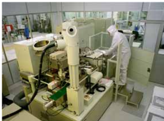
Figur 3.1 I Chalmers MC2-hus finns elektronstrålel-tografer som inte får utsättas för mer än 0,1 \mu\text{T} magnetfältvariation.
